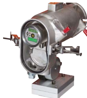
Das Schutzgehäuse ThermoJacket erlaubt den Einsatz bei Umgebungstemperaturen bis 315°C.
