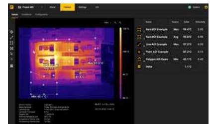
Die Kamera TV30SA bietet Remote-Zugriff über einen Webbrowser, sodass Anwender in einer einzigen Kamera mehrere Untersuchungsbereiche einstellen können.
